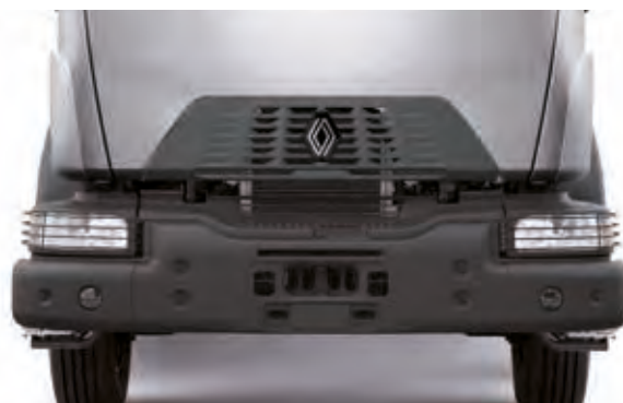
ALL STEEL BUMPER (D) for intensive use.
